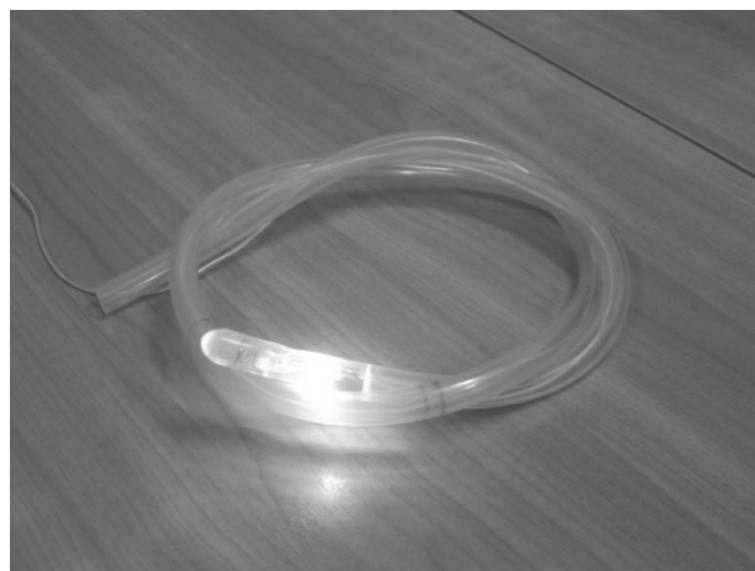
Рис. 1. Трансиллюминационный фототензометрический зонд
